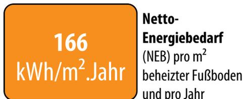
Dieser Bedarf ist die Wärmezufuhr, die von der Heizung bereitgestellt werden muss, um die Innentemperatur der Wohnung konstant zu halten. Er hängt ab von den Verlusten durch die Wände entsprechend ihrer Wärmedämmung, den Verlusten durch mangelnde Luftdichtigkeit, den Verlusten durch die Belüftung, aber auch von den Solarbeiträgen und den internen Beiträgen.
